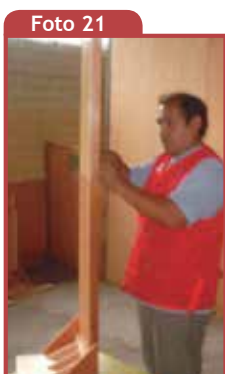
Foto 21. Auxiliar (encuestador de consumo) asegura los pernos pivot del tallímetro que permiten que los cuerpos del tallímetro se mantengan unidos. Foto 22. Auxiliar (encuestador de consumo) coloca el tallímetro en una superficie plana y nivelada. Foto 23. Auxiliar (encuestador de consumo) asegura el tallímetro en una superficie plana (pared) con cinta masking tape .
